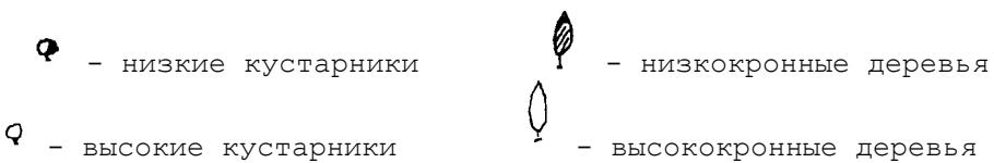
Рабочую схему составляет проектная организация. Она определяет состав древесных и кустарниковых пород, их размещение по рядам, а также количество рядов, ширину междурядий и размещение растений в рядах.
