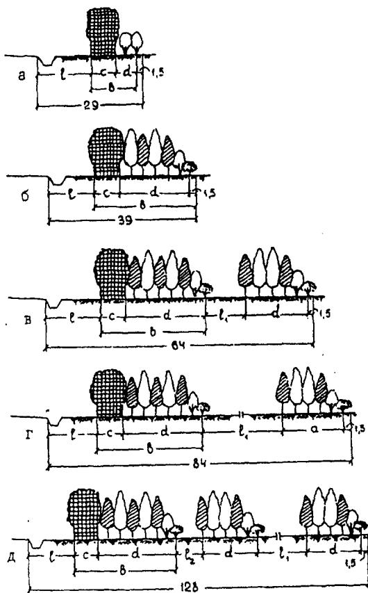
Рисунок 4. Типовые схемы усиления существующих снегозащитных лесных насаждений вдоль автомобильных дорог при объеме снегоприноса (м<sup>3</sup>/м):
