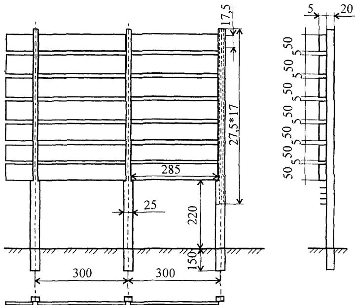
Рисунок 8. Снегопредупреждающий керамзитобетонный забор
