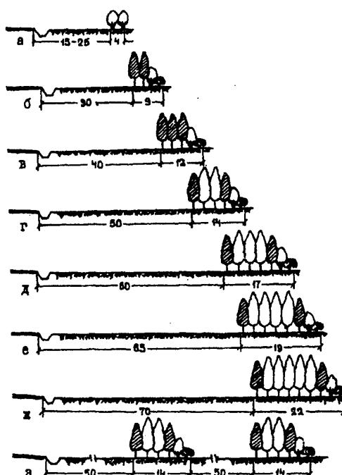
Рисунок 2. Типовые схемы снегозащитных лесных насаждений
