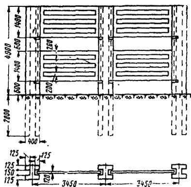
Рисунок 6. Железобетонный снегозадерживающий забор
